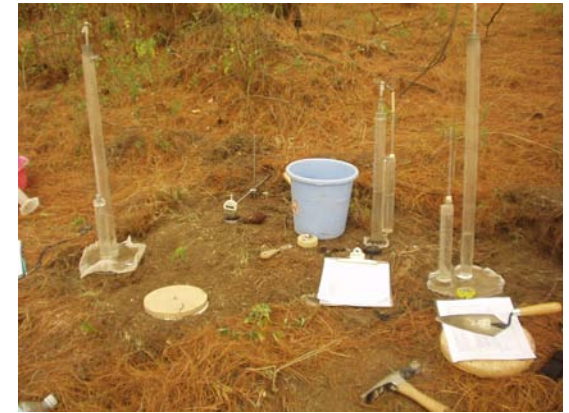
Infiltromètres à disques
