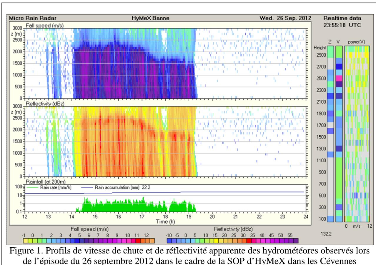
Figure 1. Profils de vitesse de chute et de réflectivité apparente des hydrométéores observés lors de l'épisode du 26 septembre 2012 dans le cadre de la SOP d'HyMeX dans les Cévennes
