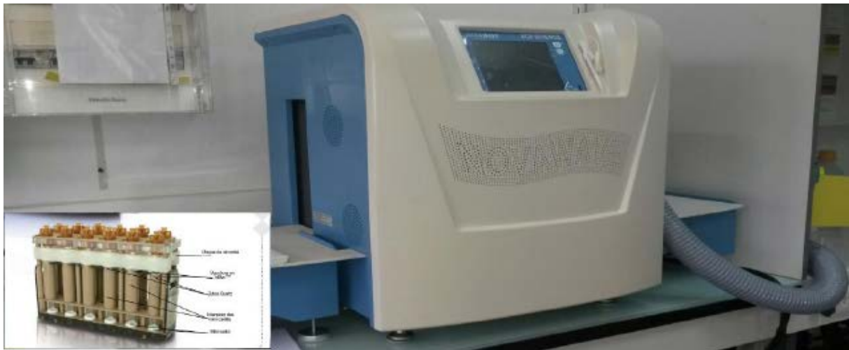
Figure 3 - Digesteur Micro-onde SCP science 'NOVAWAVE' installé au LTHE. Insert : rack de cellules extractives avec contrôle individuel de la température. Crédit : Marie-Christine Morel.
