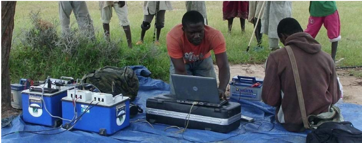
S. Kemgang réalisant un sondage par Résonance Magnétique des Protons dans l'extrême nord du Cameroun (Photo prise par M. Boucher en 2012 crédit IRD)
