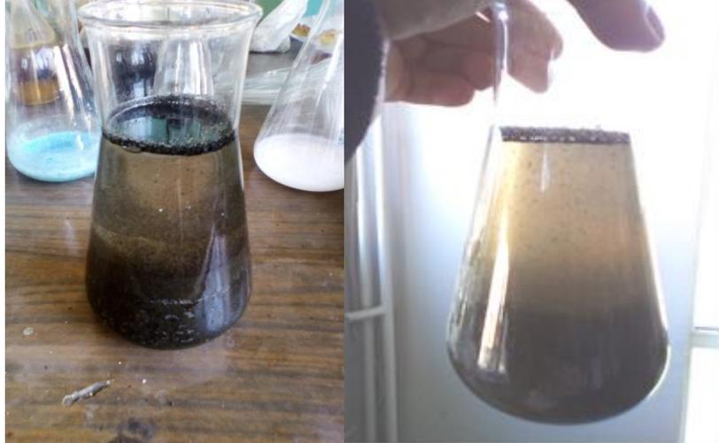
**Figure 3. Séparation du charbon. Il est moins dense et flotte ensuite à la surface de la solution de bromoforme dans un verre Erlenmeyer**
