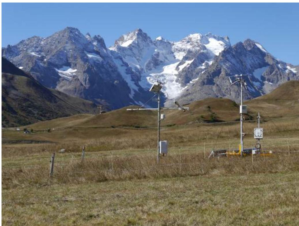
Illustration 1. Vue d'ensemble de l'instrumentation FLUXALP en septembre 2014 avec la station éco-climatique (à gauche) et le dispositif de mesure des flux (à droite). En arrière plan, le col du Lautaret et le massif de la Meije. Crédit: Philippe Choler, LECA.
